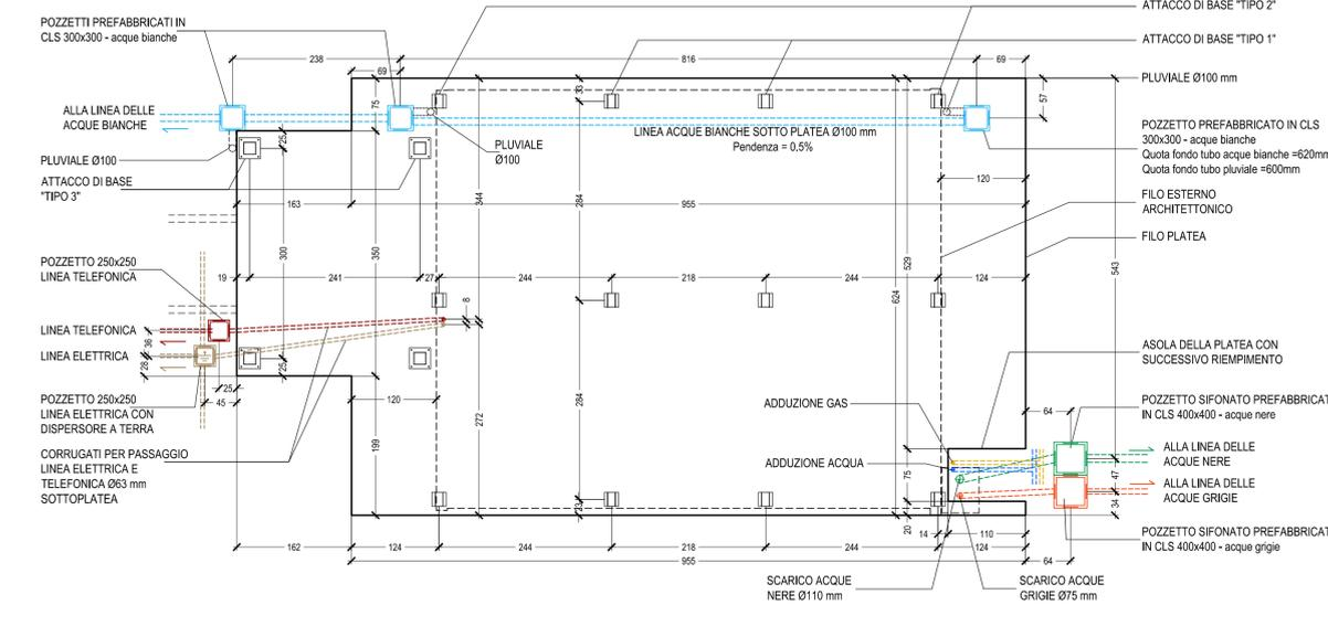
**S.A.E. 60mq - PLATEA DI FONDAZIONE CON SISTEMI DI CONNESSIONE ED INTERFERENZE IMPIANTI
