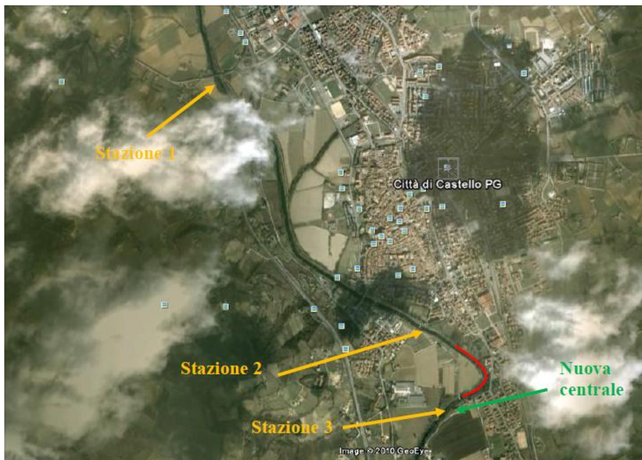
Figura 14: Stazioni di campionamento: Stazione 1 collocata a monte dell'opera di presa e di Città di Castello, Stazione 2 a monte della presa, Stazione 3 collocata a valle del futuro fabbricato di centrale. In rosso viene evidenziato l'invaso creato dalla soglia esistente posta circa 130 m a monte della zona di progetto lungo il quale è inaccettabile ogni sorta di campionamento I.B.E.
