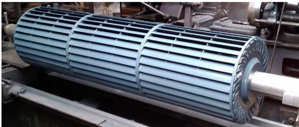
Figura 5.2 – Girante di una turbina tipo Banki-Ossberger.
