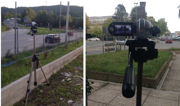
Foto 7 – Esempio di installazione per il rilievo con telecamere
