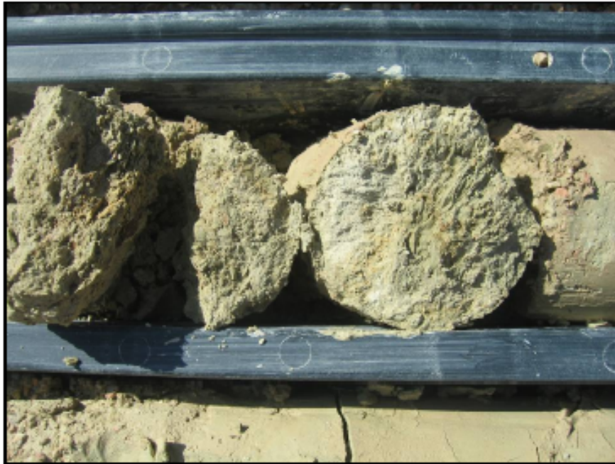
FOTO N°5: PARTICOLARE DELLA CASSETTA N°2 DEL SONDAGGIO N°1 (MARNA)
