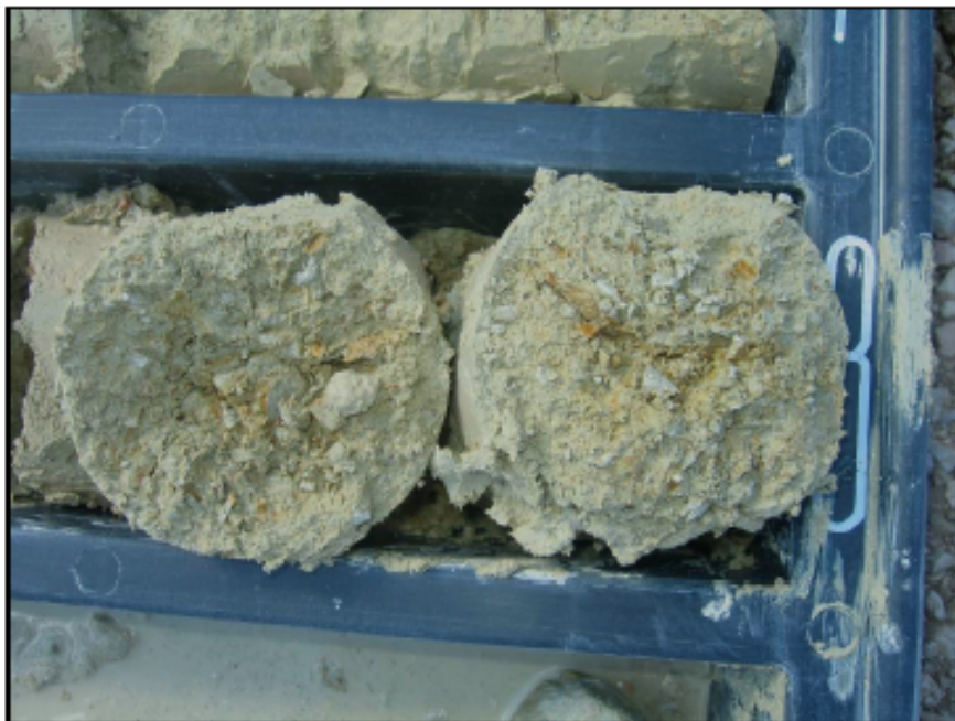
FOTO N°6: PARTICOLARE DELLA CASSETTA N°2 DEL SONDAGGIO N°1 (MARNA)
