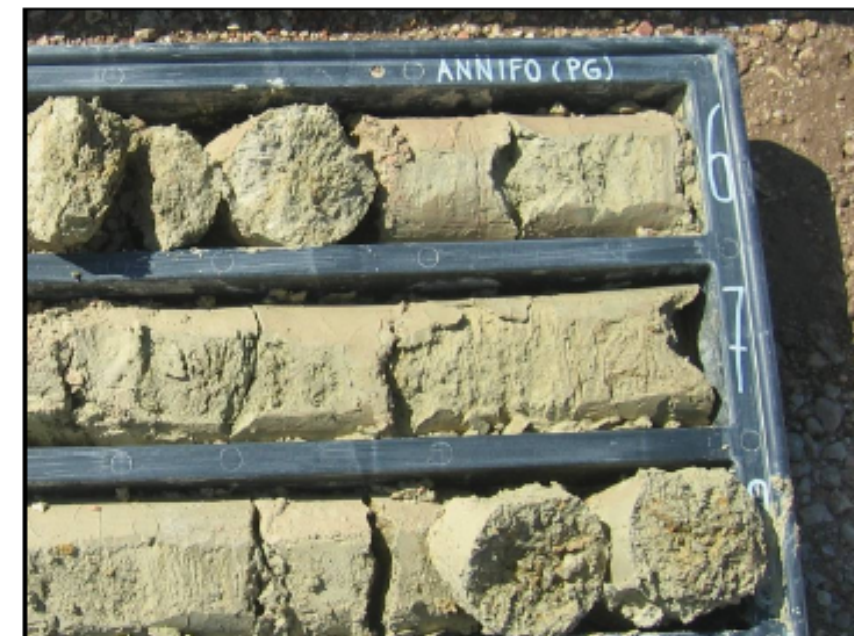
FOTO N°4: PARTICOLARE DELLA CASSETTA N°2 DEL SONDAGGIO N°1 (MARNA)
