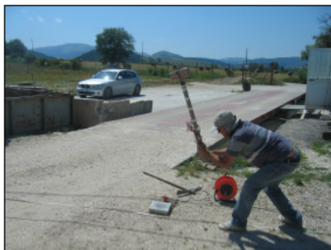
FOTO N°2: ENERGIZZAZIONE ONDE DI COMPRESSIONE
