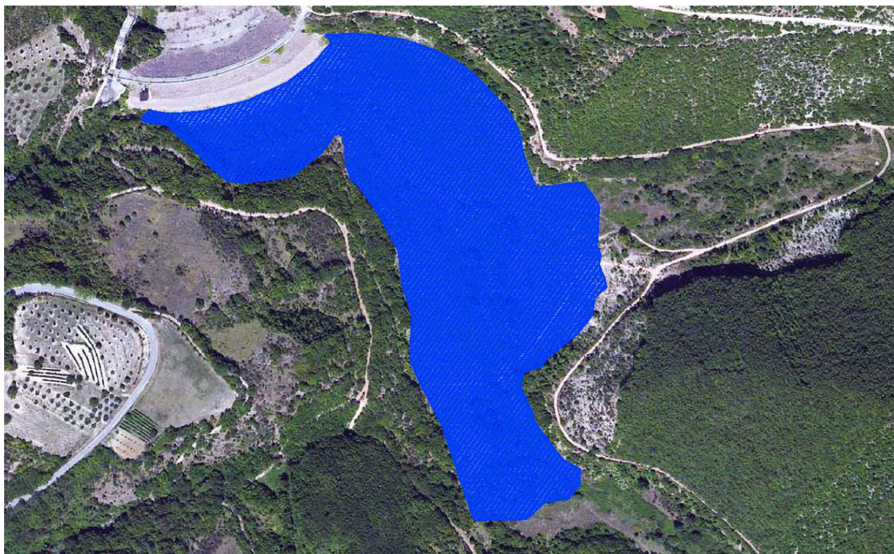
Figura 5 – Ripresa aereofotogrammetrica del serbatoio con indicazione della superficie di invaso a quota 520,37 m s.l.m.
