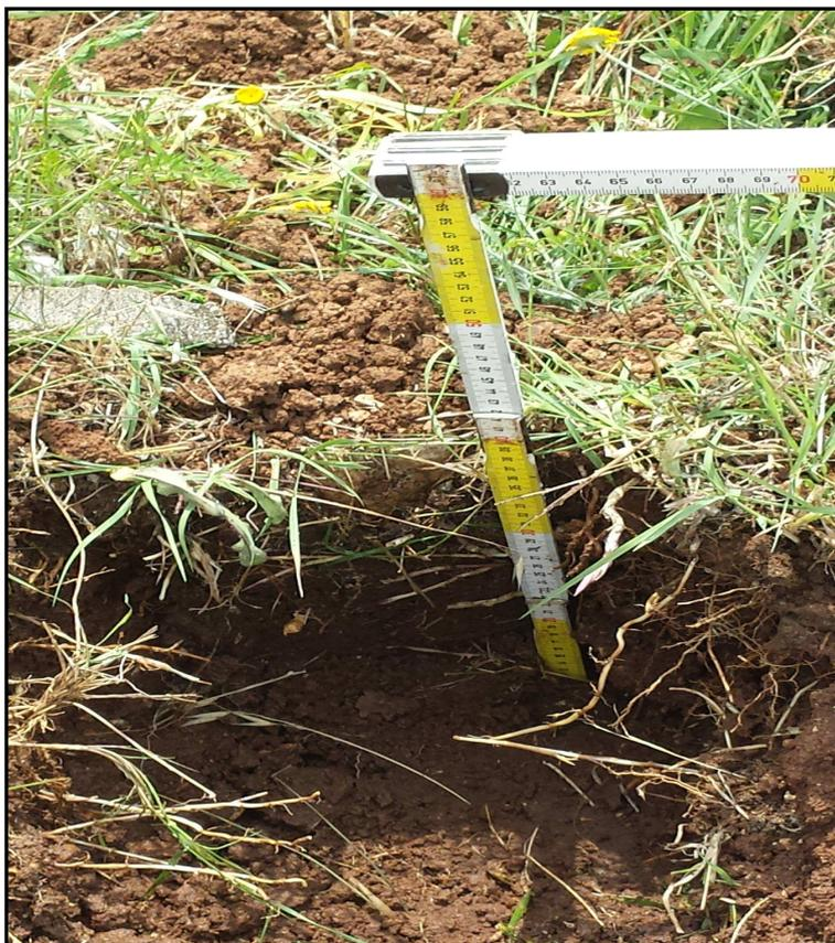
Fig. 7.23: Pozzetto per prelievo campione e prova di permeabilità
