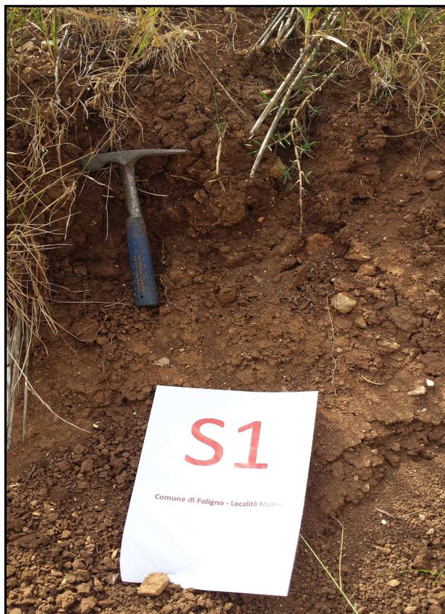
Fig. 7.20: Particolare della sezione di scavo per analisi pedologica e prelievo campione di terreno
