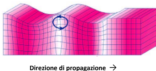
Fig. 7 - Rappresentazione grafica della propagazione delle onde superficiali di Rayleigh caratterizzata dall'oscillazione polarizzata in un piano verticale e con movimento delle particelle retrogrado rispetto alla direzione di propagazione dell'onda.
