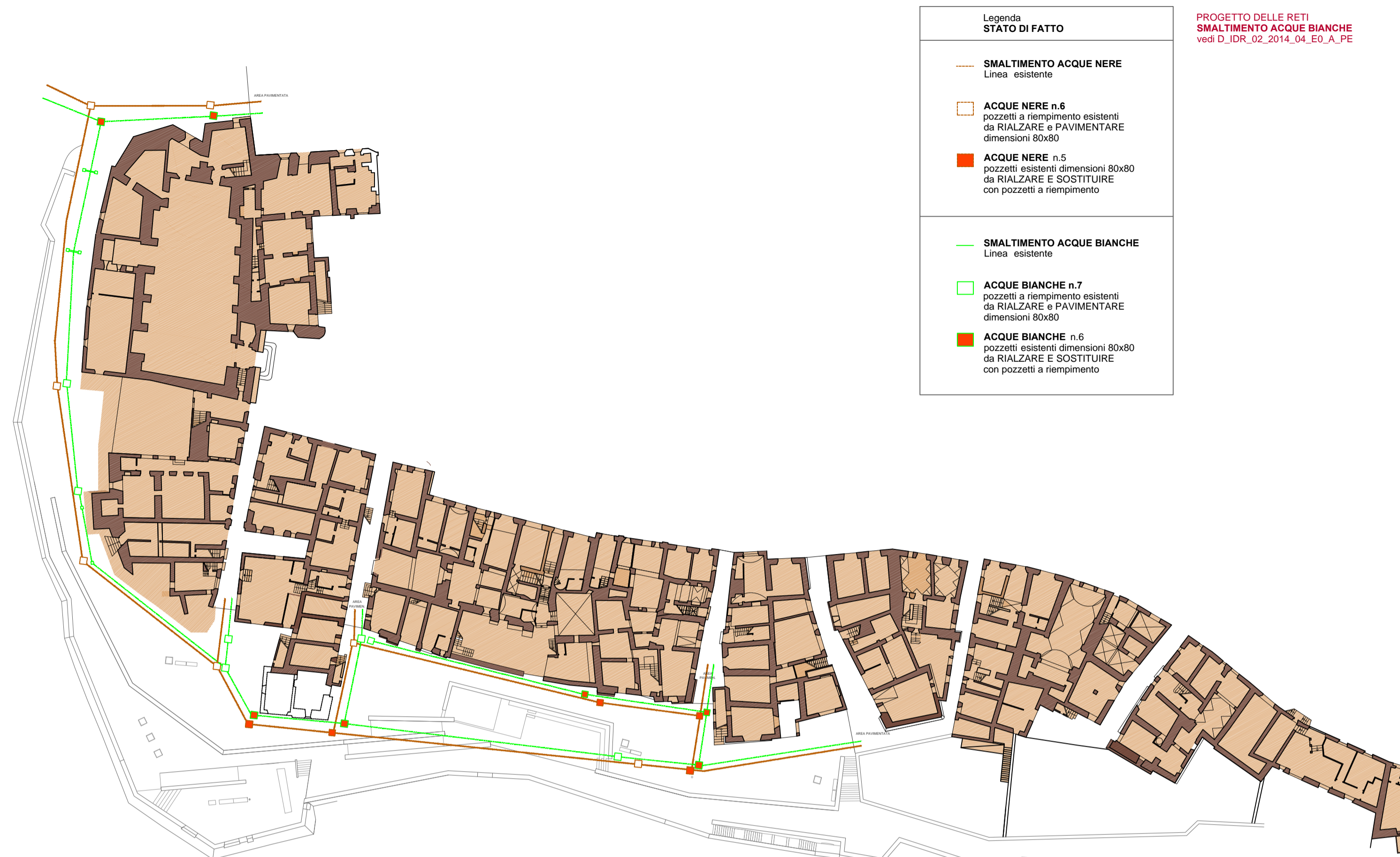
PLANIMETRIA RETI ESISTENTI: ACQUE BIANCHE e ACQUE NERE - scala 1:500
