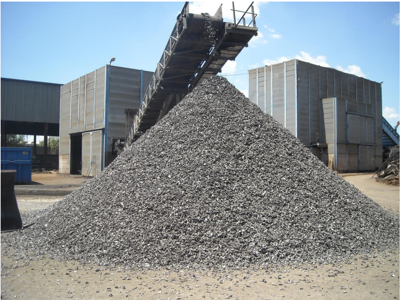
Scarico rottame frantumato prodotto dall'impianto
