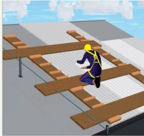
Predisposizione intavolato con sistema anticaduta linea vita
