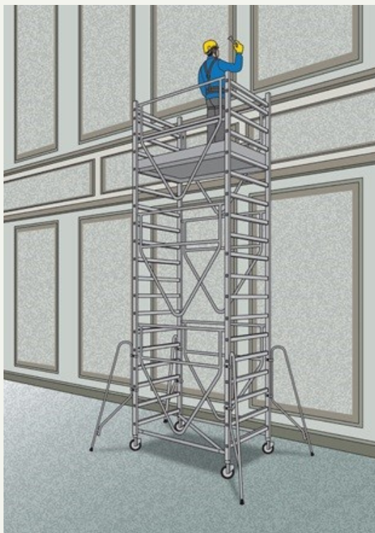
Esempio di trabattello con scala a pioli verticale
