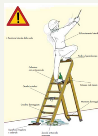
Esempio uso errato – (Quaderni tecnici INAIL – scale portatili)
