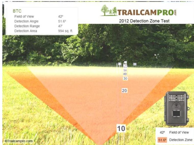
Figura 2 Esempio di detection zone
