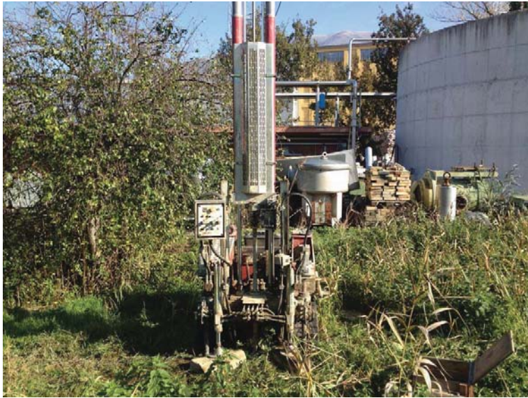
FOTO 1 : Strumentazione utilizzata per l'esecuzione della prova CPT 2.
