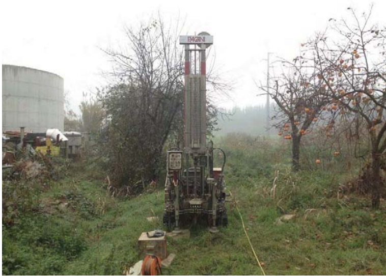
FOTO 1 : Strumentazione utilizzata per l'esecuzione della prova CPT 1.
