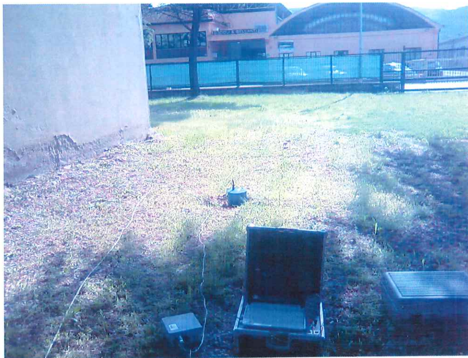
Fase di acquisizione del segnale sismico durante la prova HVSR. Al centro è visibile il geofono Lennartz 3D-5S con frequenza di risonanza 0.2 Hz.
