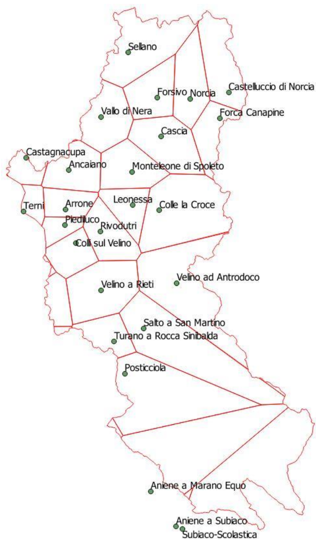
Fig. 1 – Bacino idrografico del F.Nera con chiusura all'idrometro di Terni, posizione dei pluviometri di riferimento e indicazione dei poligoni di Thiessen.
