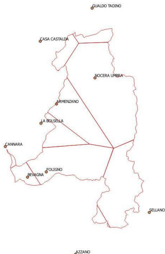
Fig. 1 – Bacino idrografico del F.Topino con chiusura all'idrometro di Bevagna, posizione dei pluviometri di riferimento e indicazione dei poligoni di Thiessen.
