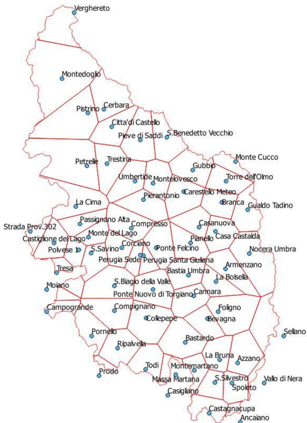
Fig. 1 – Bacino idrografico del F.Tevere con chiusura all'idrometro di Monte Molino, posizione dei pluviometri di riferimento e indicazione dei poligoni di Thiessen.
