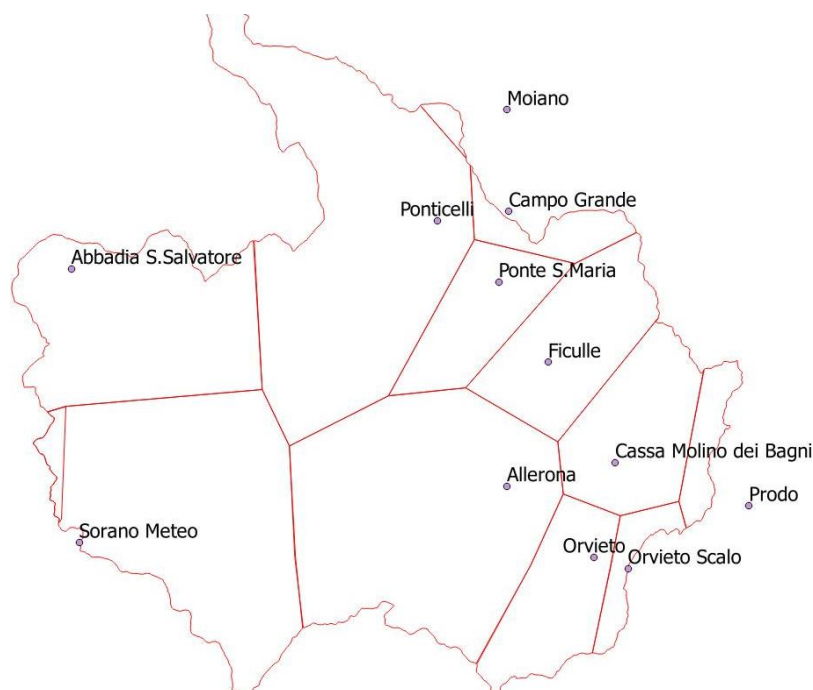
Fig. 1 – Bacino idrografico del F. Paglia con chiusura all'idrometro di Orvieto Scalo, posizione dei pluviometri di riferimento e indicazione dei poligoni di Thiessen.
