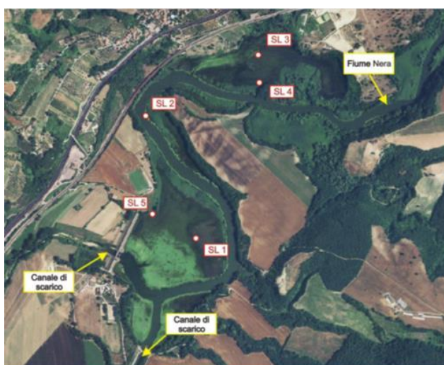
Fig. 9.8-13 – Localizzazione dei punti di campionamento dei sedimenti
