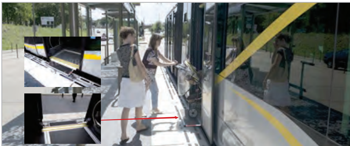
Figura 122. Accostamento alla fermata ed alta accessibilità con incarozzamento a raso (Nantes)
