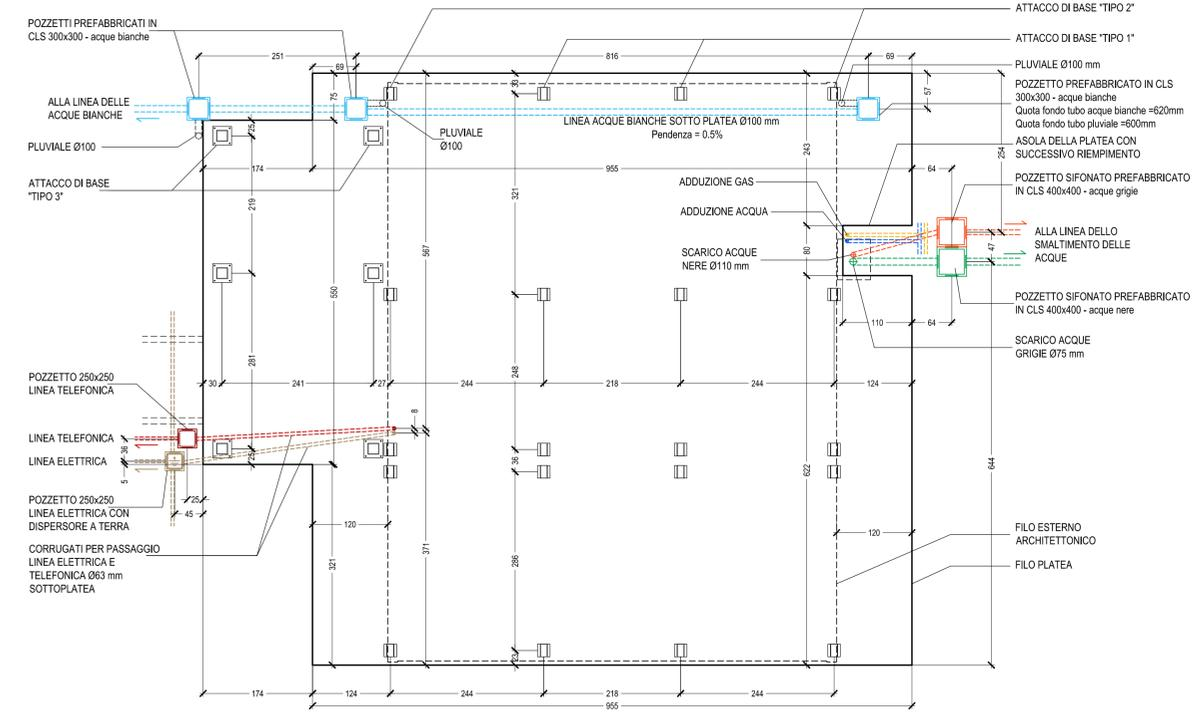
**S.A.E. 80mq - PLATEA DI FONDAZIONE CON SISTEMI DI CONNESSIONE ED INTERFERENZE IMPIANTI**
