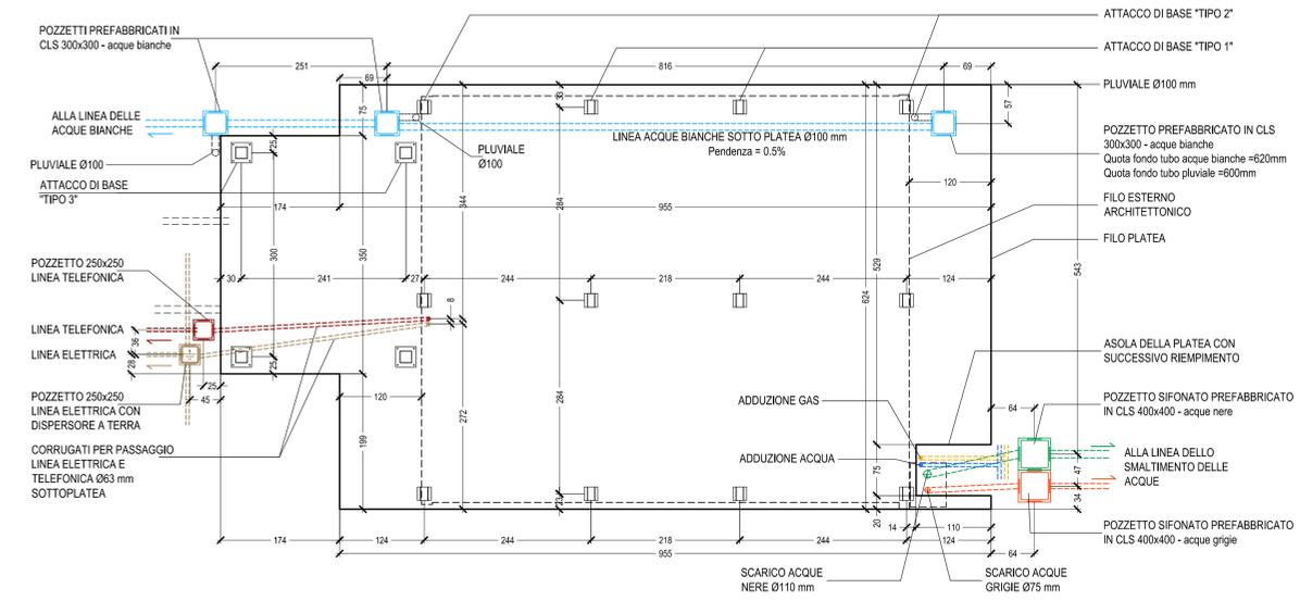
**S.A.E. 80mq - PLATEA DI FONDAZIONE CON SISTEMI DI CONNESSIONE ED INTERFERENZE IMPIANTI**
