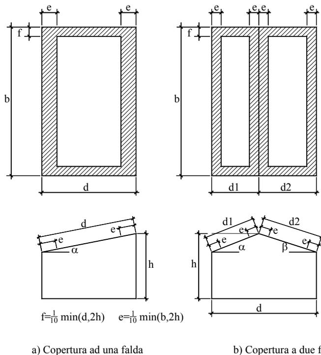
**Figura C3.3.5** – Zone di massime pressioni locali sulle coperture
