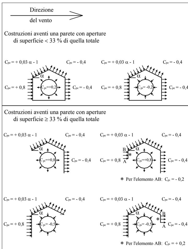
Figura C3.3.3 Coefficienti di forma per gli edifici.
