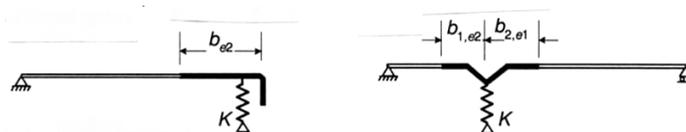
Figura C4.2.31 – Schematizzazione degli irrigidimenti
