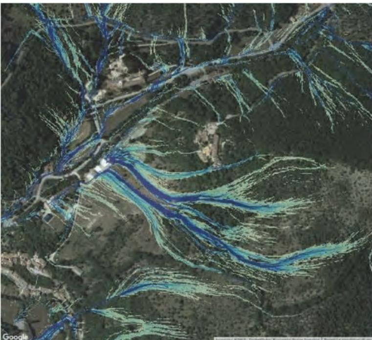
Linee di flusso individuate tramite modellazione numerica su base ortofoto.
