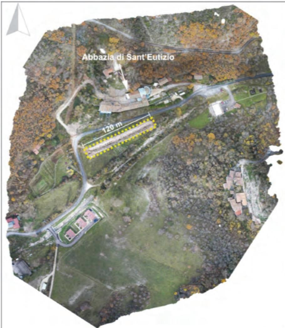
Ubicazione trincea tramite volo di drone.
