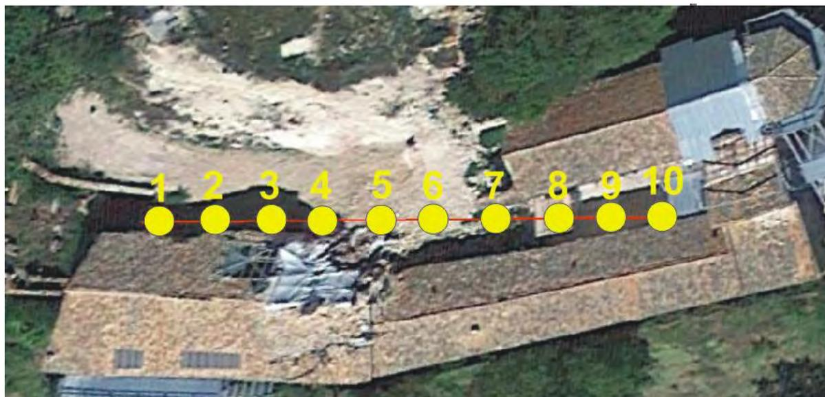
Localizzazione delle indagini HVSR realizzate sulla traccia del profilo sismico A-B (cortile interno) durante la seconda campagna di indagini.
