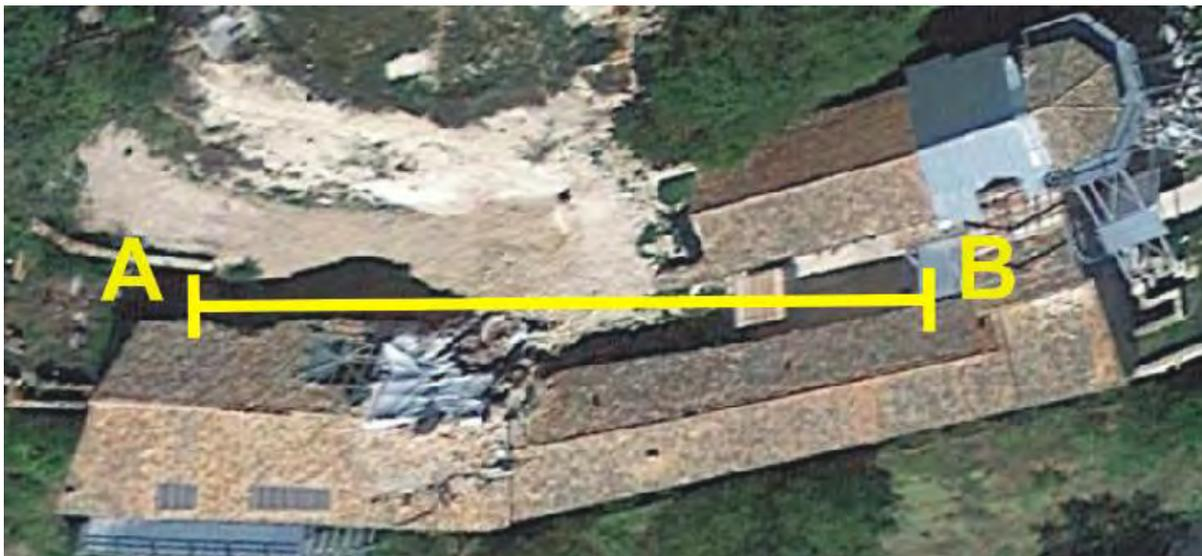
Traccia dei profili di sismica a rifrazione in onde P, Sh e Masw R e L effettuati all'interno dell'Abbazia durante la **seconda campagna di indagini** (ottobre 2019). Tutti i profili sono stati effettuati con traccia corrispondente).
