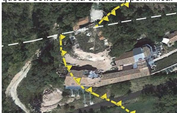
La linea tratteggiata gialla indica un elemento tettonico compressivo e la linea bianca tratteggiata indica un elemento tettonico trascorrente destro.
