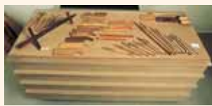
Serie di moduli e ami per la confezione delle reti
