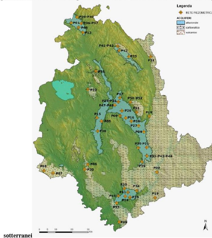
Rete piezometrica ARPA Umbria per il monitoraggio quantitativo in continuo dei corpi idrici
